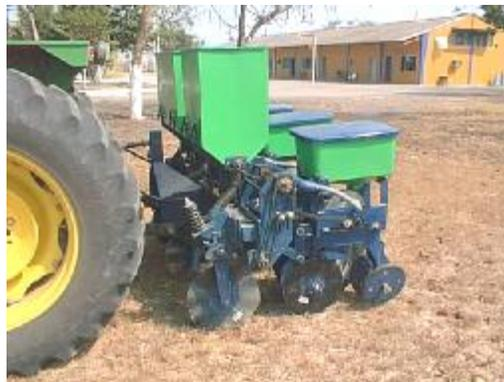
**Figura 8. Elementos que integran el prototipo de un sistema de siembra neumática, desarrollado para la evaluación en condiciones de campo.**
