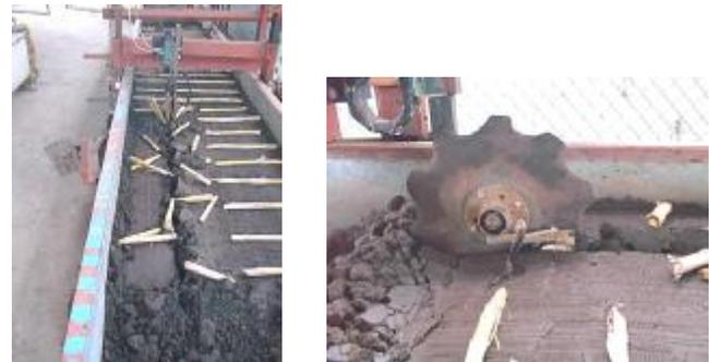
Figura 6. Sistema de simulación de fuerzas empleado en la evaluación de discos cortadores de residuo.
