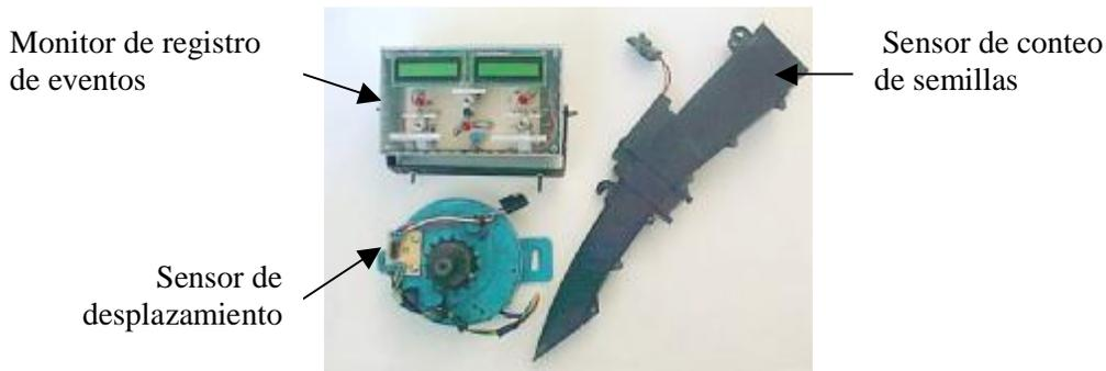
Figura 5. Elementos que integran el sistema de monitoreo de caída de semilla.
