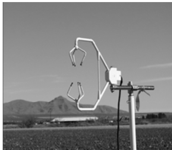
Figura 2. Muestreador de polvos (izquierda) utilizado para registrar la concentración de material particulado y un anemómetro sónico (derecha) para registrar dirección del viento en tres planos x – y – z.
